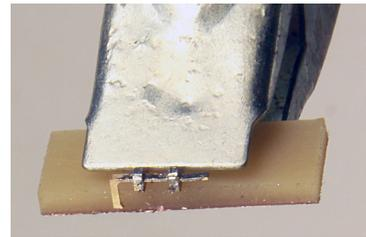
Riegelhalter u-förmig biegen (Biegenuten innen) und Riegel von rechts oder links einlöten.
