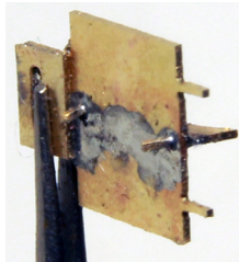
Pufferplatten je nach Puffererschaft zufeilen.
