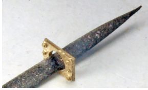
Pufferplatten je nach Puffererschaft zufeilen.
