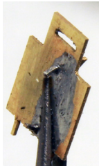
Pufferplatten je nach Puffererschaft zufeilen.
